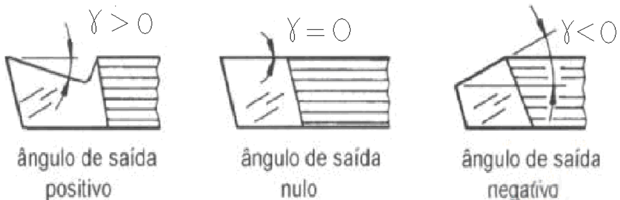
Figura 3.8 – Ângulo de saída ( \gamma ) para uma ferramenta de torno.
