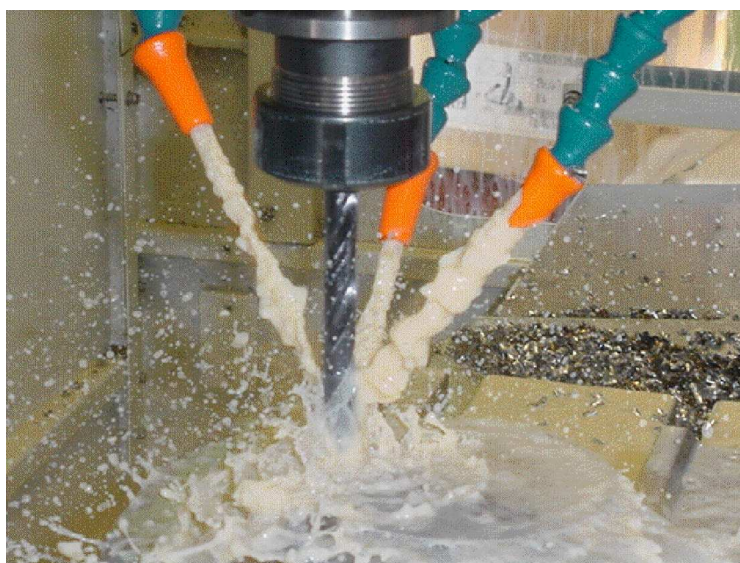
Figura 5.2 – Aplicação por jorro do fluido de corte semi-sintético, vazão total de 1230 l/h.
