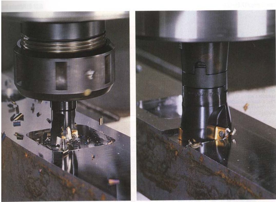
Figura 1.13 - fresas de topo para fresamento de rasgos e esquadrejamentos
