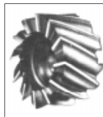
fresa cilíndrica frontal para mandril com chaveta transversal
