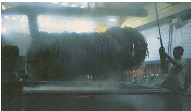
Figura 11.2 – Exemplo de produto trefilado sendo submetido à decapagem.
