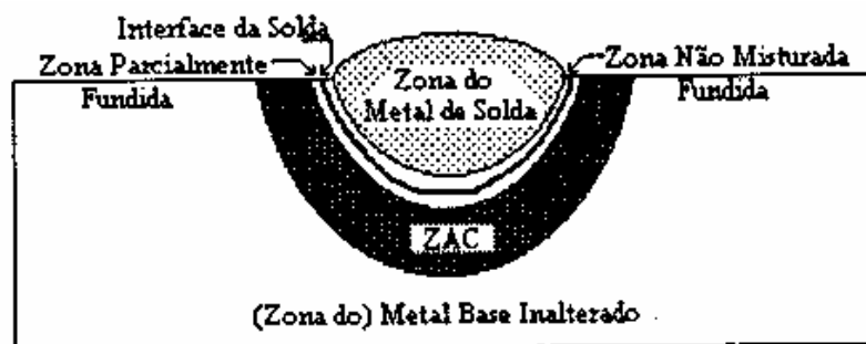
Figura 17.6 – Zonas das juntas soldadas.
