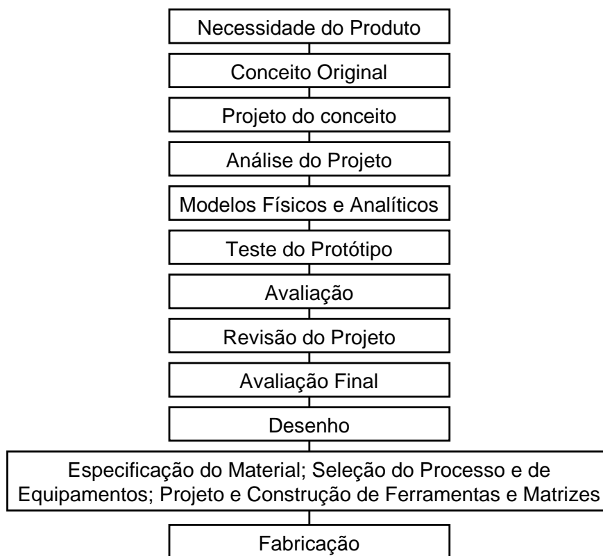
Figura 1.1 - Diagrama mostrando o procedimento requerido para o projeto de um produto, que são etapas que antecedem a fabricação.
